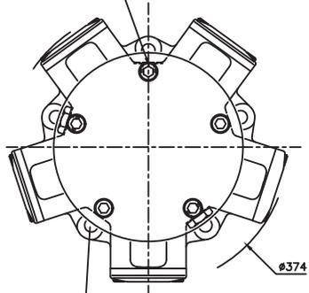
5 HOLES  $\phi 18$  EQUI-SPACED AS SHOWN ON A  $\phi 260.1$  P.C.D. SPOTFACED TO GIVE AN EFFECTIVE  $\phi 35$ .
