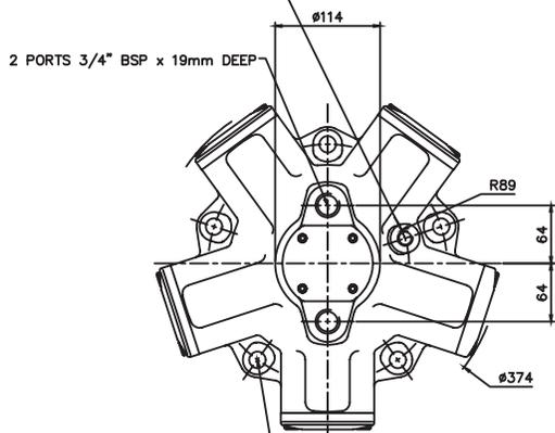
5 HOLES  $\phi 18$  EQUI-SPACED AS SHOWN ON A  $\phi 260.1$  P.C.D. SPOTFACED TO GIVE AN EFFECTIVE  $\phi 35$ .
