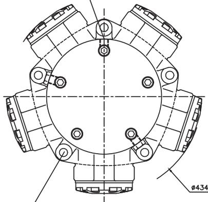
5 HOLES  $\phi 18$  EQUI-SPACED AS
