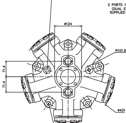
5 HOLES  $\phi 18$  EQUI-SPACED AS
